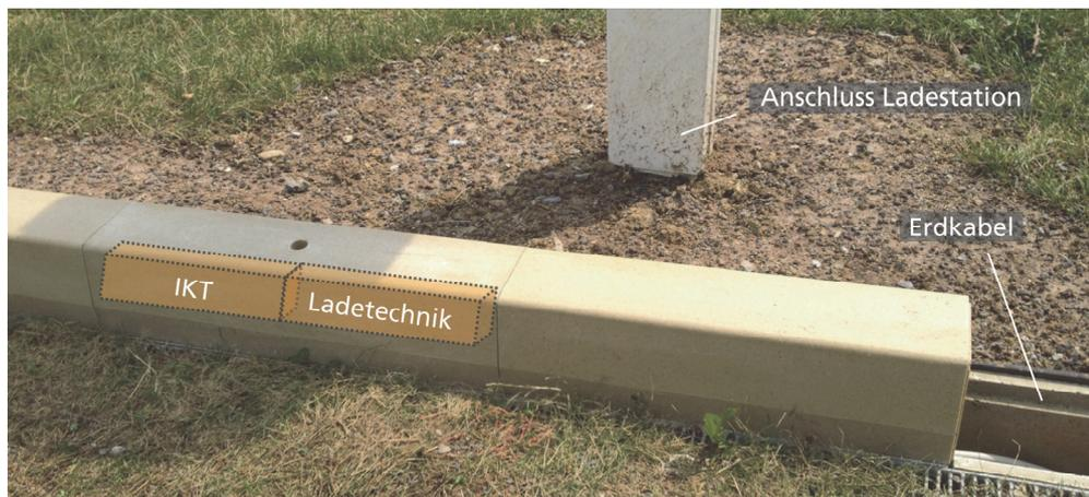
**Demonstrator für den Formstein mit integriertem Stromkabel aus dem Projekt GeMo**
